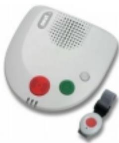
Wird Hilfe benötigt, muss nur der Alarmknopf gedrückt werden. Über ein Funksignal wird die Basisstation aktiviert, die dann über die Telefonleitung eine Verbindung zur Rettungsleitzentrale in Linz herstellt. Dort kann auf einem Bildschirm abgelesen werden, wer den Alarm ausgelöst hat. Gleichzeitig wird eine Freisprecheinrichtung geöffnet, die eine Sprechverbindung mit dem Teilnehmer ermöglicht, auch wenn er das Telefon nicht mehr erreichen kann.
